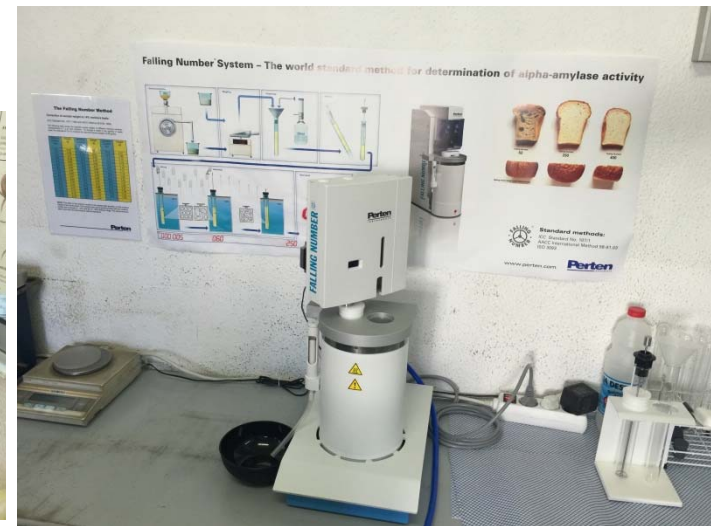
Equipo para medida de Falling Number. Jerez de la Frontera, mayo de 2016
